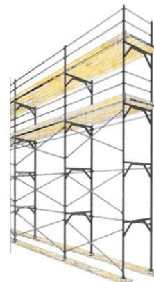
I ponteggi, dovranno essere montati, smontati o trasformati sotto la sorveglianza di un preposto e ad opera di lavoratori che hanno ricevuto una formazione adeguata e mirata alle operazioni previste
